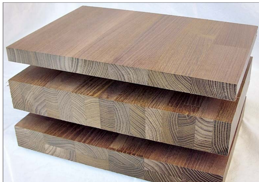
Gedämpfte Robinien-Leimholzplatten mit verschiedener Verleimung der Lamellen
