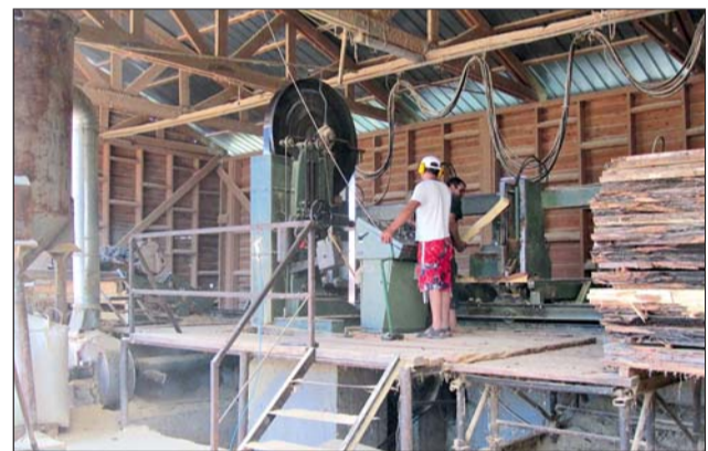
Mit einer Gatter- und einer Bandsäge (oben) werden rund 10000 Fm Robinie und rund 2000 Fm Eiche eingeschnitten.
