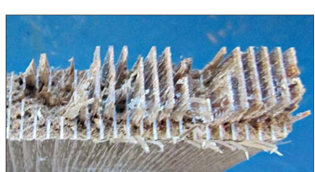
Bruchbild: In unzähligen Prüfungen nach DIN und EN wurden Biege- und Zugfestigkeit sowie das Delaminierungsverhalten gemessen, um die idealen Produktionsparameter zu ermitteln.
