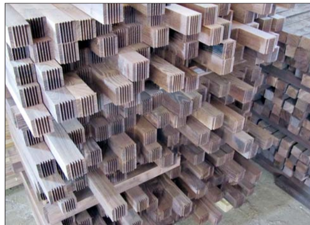
Keilgezinkte Kanteln vor der Verleimung
