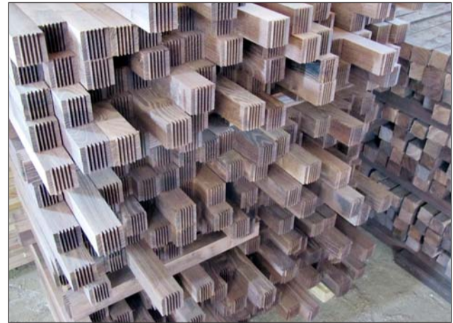
Keilgezinkte Kanteln vor der Verleimung
